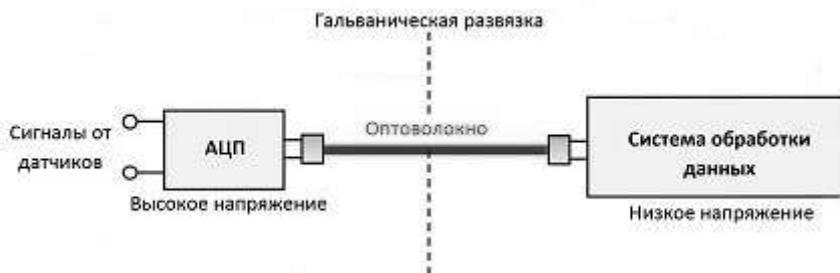
Рис. 2. Схематичное устройство контрольно-измерительных системы
