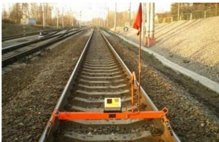
Рис. 1. Путеизмерительная тележка ПТ-7МК
