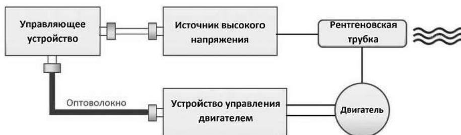
Рис. 1. Схематичное устройство рентгеновского аппарата
