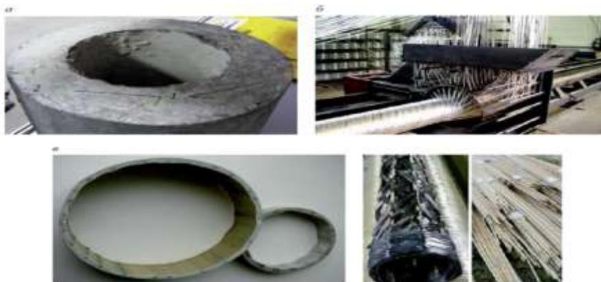
Рис. 2. Опоры с применением полимерных композитных материалов: а- бетонная опора (1- стеклопластиковая арматура, 2- бетон); б- стеклопластиковая опора путем намотки; в- комбинированная стеклопластиковая опора: справа- начало намотки, слева- готовая деталь
