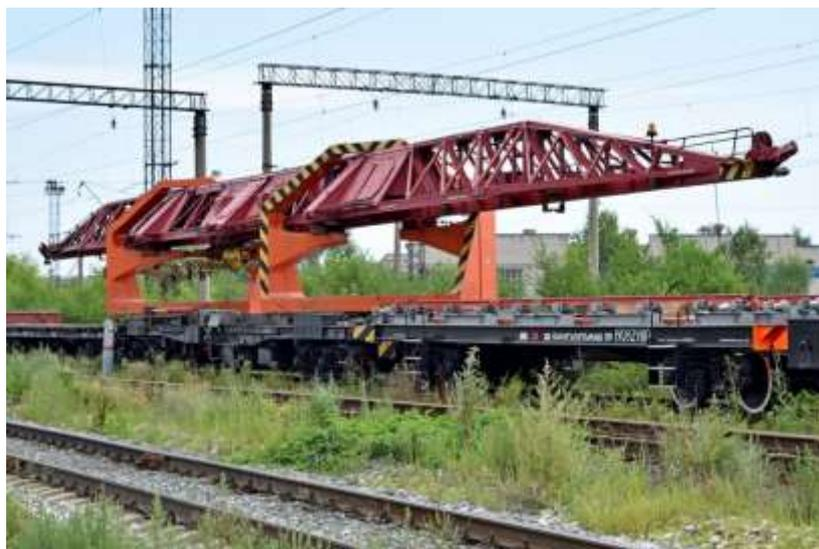
Рис.1 Укладочный кран УК-25СП
