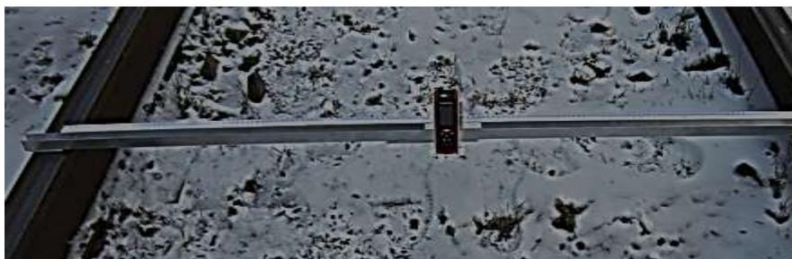
Рис. 1. Бесконтактный измеритель параметров контактной сети на базе лазерного измерителя расстояний
