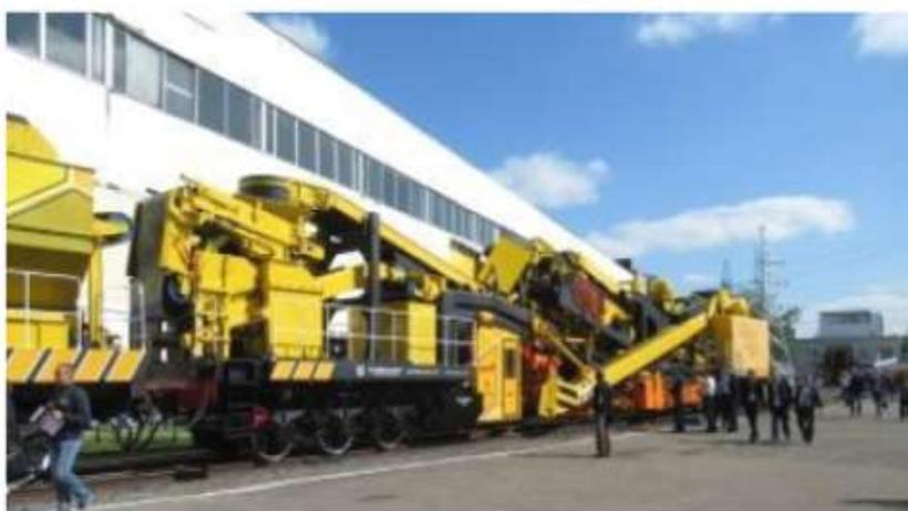
Рис. 1 Новые машины для очистки щебня.
