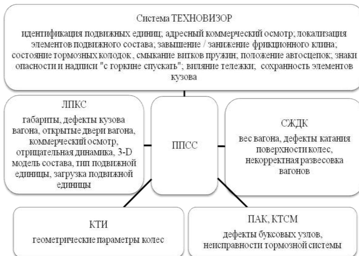
Рис.1. Пример организации системы диагностики подвижного состава [3]
